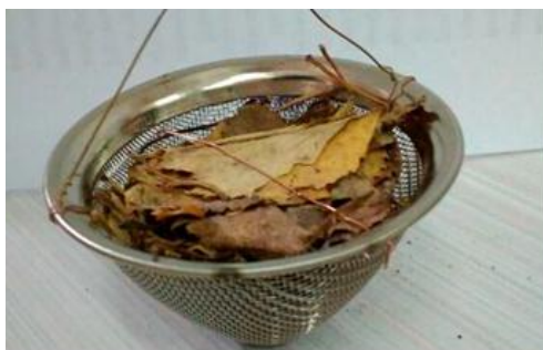
Рис. 1. Образец утрамбованной березы и хвои сосны до проведения эксперимента, уложенной в буюксу
